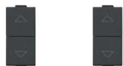
09060.CM Conmutador 2P 10 AX, OFF central. Profundidad: 33,5 mm 09062.CM 2 pulsadores interbloqueados 1P NO 10 A. Profundidad: 29 mm
