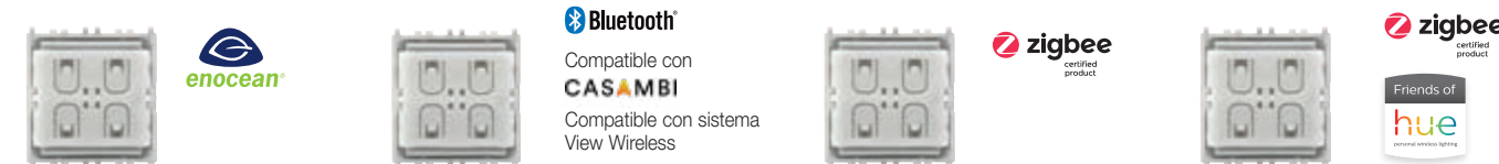
03955 Mando plano de cuatro pulsadores con transmisor por radiofrecuencia 868 MHz, estándar EnOcean, alimentación Energy Harvesting suministrada por el generador electrodinámico incorporado, 2 módulos. 03925 Mando plano de cuatro pulsadores con transmisor por radiofrecuencia 2,4 GHz, estándar Bluetooth Low Energy, alimentación Energy Harvesting suministrada por el generador electrodinámico incorporado, 2 módulos. 03905 Mando plano de cuatro pulsadores con transmisor por radiofrecuencia 2,4 GHz estándar ZigBee Green Power sin baterías, alimentación suministrada por el generador electrodinámico incorporado, 2 módulos. 03906 Mando plano de cuatro pulsadores con transmisor por radiofrecuencia 2,4 GHz, estándar Zigbee Green Power y Friends of Hue, alimentación Energy Harvesting suministrada por el generador electrodinámico incorporado, 2 módulos.
