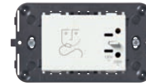
09290 Toma para afeitadora con transformador de aislamiento 20 VA, alimentación 230 V~ 50/60 Hz, salidas 230 V~ y 120 V~ - 3 módulos. Profundidad: 42 mm
