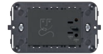
09290.CM Toma para afeitadora con transformador de aislamiento 20 VA, alimentación 230 V~ 50/60 Hz, salidas 230 V~ y 120 V~ - 3 módulos. Profundidad: 42 mm
