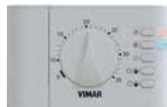
02900.1 Termostato electrónico para control ON/OFF de la temperatura ambiente (calefacción, aire acondicionado), dispositivo de control de la temperatura de clase I (aportación 1%), salida de relé conmutada 5(2) A 240 V~, alimentación con baterías AA LR6 1,5 V (no suministradas), instalación de superficie, blanco
