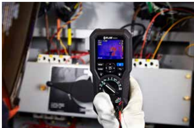
Exploración térmica de un cuadro eléctrico
